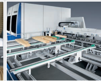
Ein- und Auslaufautomatisierung für "Mannarme" Fertigung
