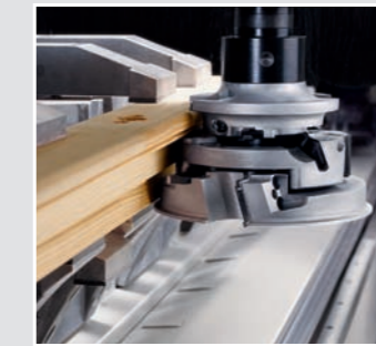
Power satt: Hauptspindel mit bis zu 30 kW
