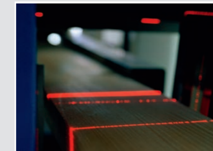
Prozessicherheit durch Rohteilvermessung und Kollisionsüberwachung
