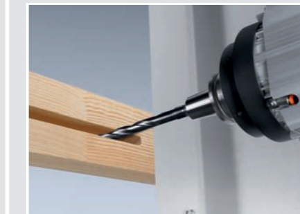
Horizontales Fräsaggregat für große Ausfräsungen, wie z.B. Schlosskasten
