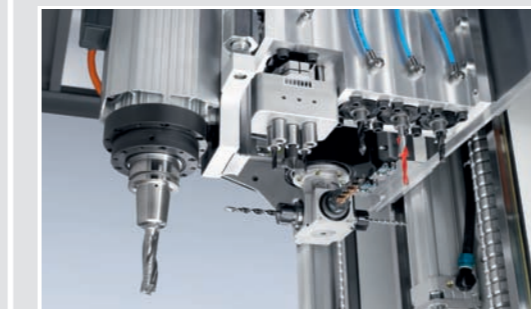
Kombination Mehrspindelbohrkopf horizontal/vertikal mit vertikalem Fräser
